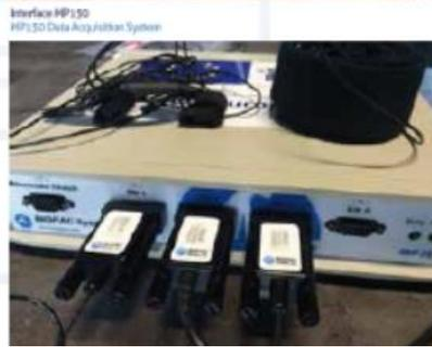
Capteurs physiologiques permettant de mesurer les fluctuations du rythme cardiaque, de l'activité électrique de la peau (microsudation) et la respiration
