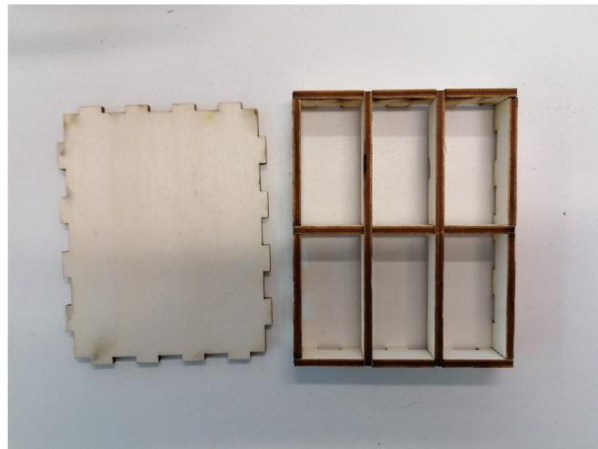
Figure 5 : Photographie du moule pour 6 briques
