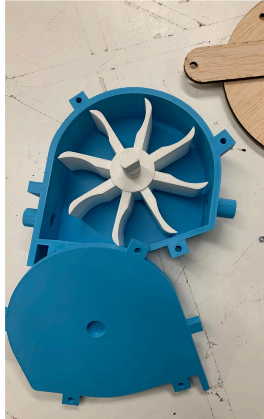
1. Impression en 3D de la roue à eau : quelques essais infructueux avant d'avoir un résultat plutôt convaincant.
