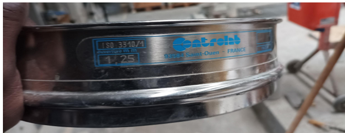
image 1 : tamis utilisé de 1,25mm d'ouverture
