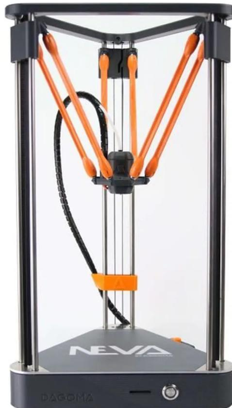
L'impression 3D ou fabrication additive est un procédé de fabrication qui permet d'obtenir un prototype assez rapidement ce qui permet d'accélérer les phases d'avant-projet. Le procédé repose sur un principe très simple : le dépôt de matière couche par couche permet de créer le volume désiré. En procédant ainsi, on peut donc réaliser de façon simple des pièces qui auraient pris des heures voire des jours à réaliser avec les moyens de fabrication classique.
