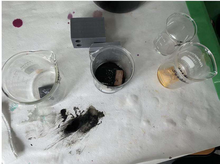
PET Acide chlorhydrique à gauche - PLA/liège et Hips Acétone au centre-PLA Soude à droite
